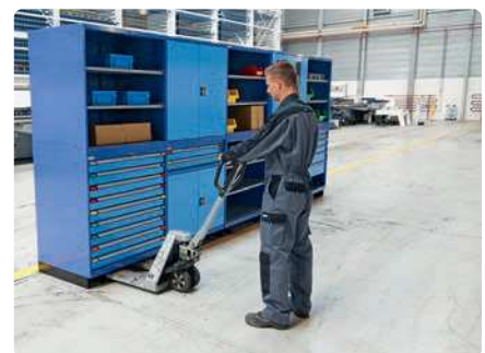
Étape 3 Placement du module au moyen d'un socle pour transpalette intégré
