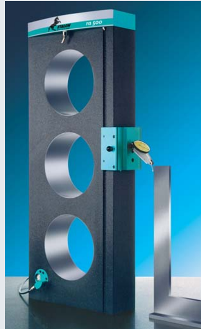
Etalonnage d'une équerre à butée à l'aide du mesureur ETALON RA.
